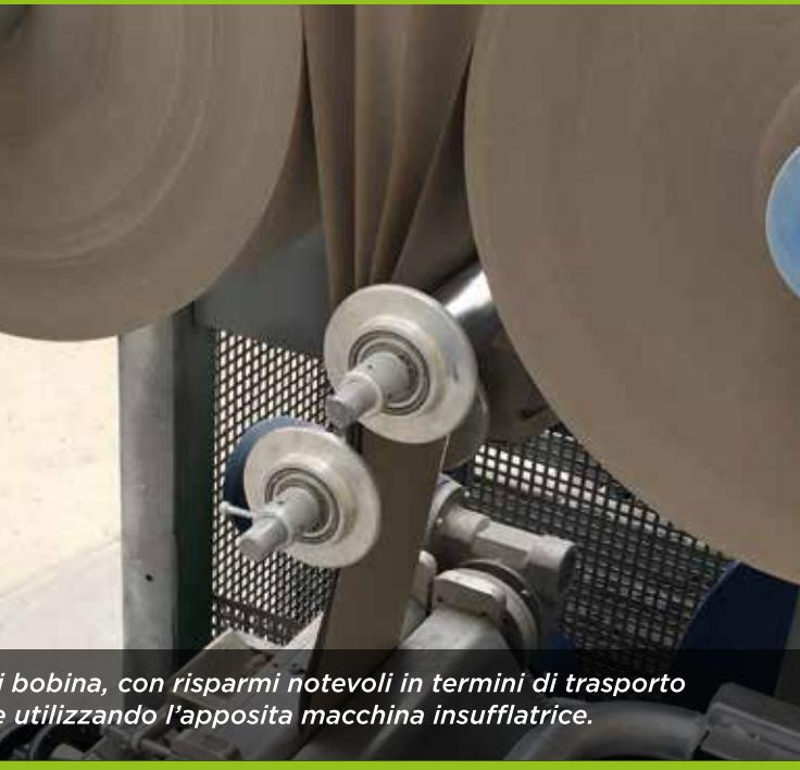
*Il prodotto può essere utilizzato direttamente sotto forma di bobina, con risparmi notevoli in termini di trasporto e logistica, realizzando la fioccatura direttamente in cantiere utilizzando l'apposita macchina insufflatrice.*
